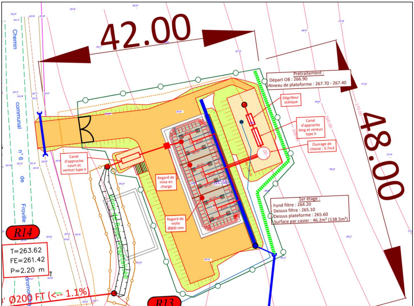
Figure 19 : Plan de la STEU projetée (Stade AVP)
